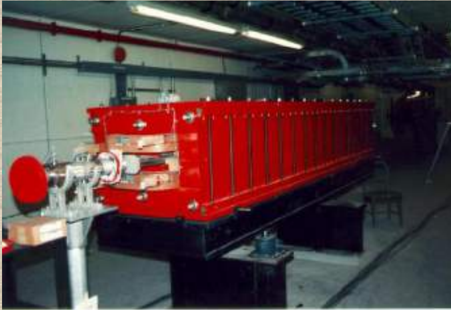
Magnete quadrupolare per il foccheggiamento
